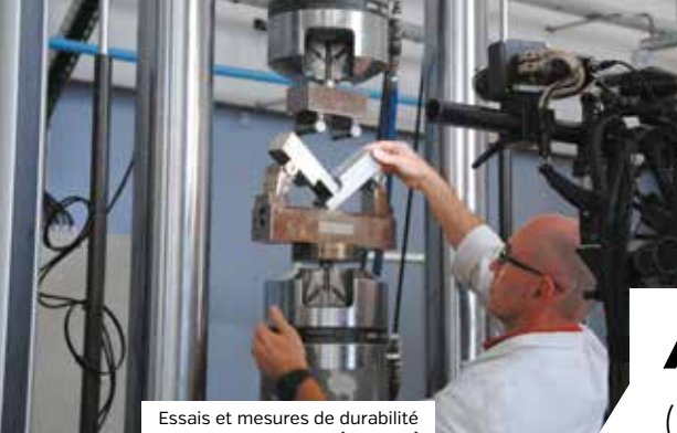
Essais et mesures de durabilité d'assemblages collés (cf. focus)
